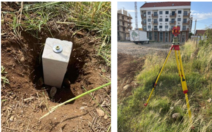
Slika 3: Biljega tačke geodetske mreže specijalne namjene (lijevo) i signalisana geodetska tačka mreže specijalne namjene (desno)
