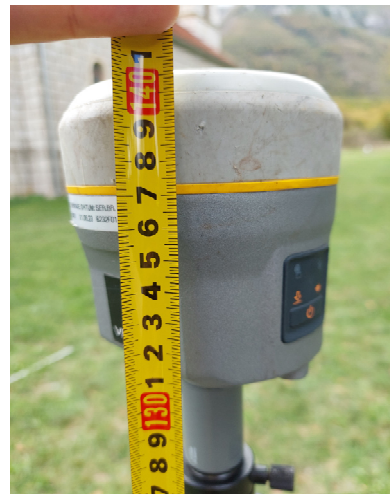
Slika 10. GNSS prijemnik tokom mjerenja (lijevo), dokumentovanje visine antene (desno)
