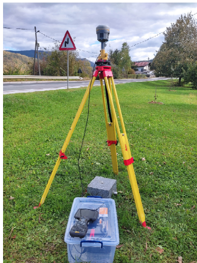
Slika 10. GNSS prijemnik tokom mjerenja (lijevo), dokumentovanje visine antene (desno)
