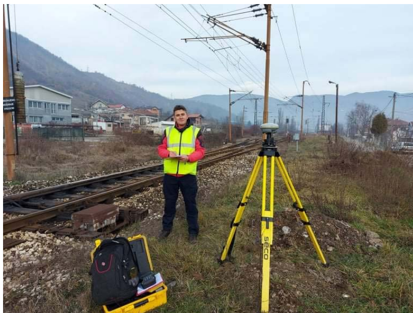
Slika 3. Mjerenja statičkom GNSS metodom i evidentiranje podataka u zapisnik GNSS opažanja.
