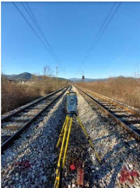
Slika 8. Mjerenje poligonih vlakova.
