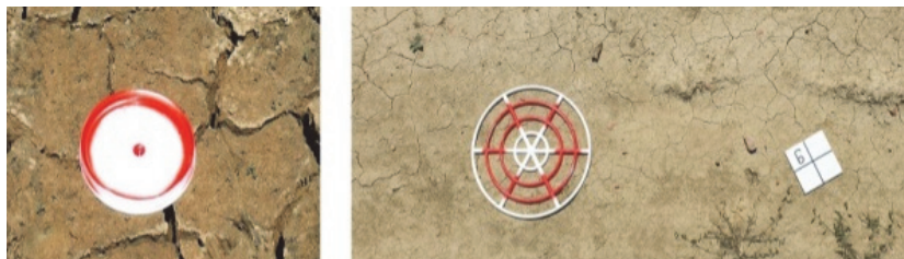
Slika 4. Kontrolni markeri korišćeni u svrhu obezbjeđivanja "GCP"
