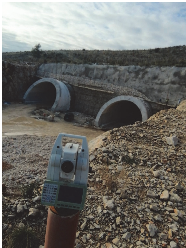
Slika 5. Snimanje portala tunela Počitelj u svrhu računanja površine ugrađenog kamena u kosinu portala.
