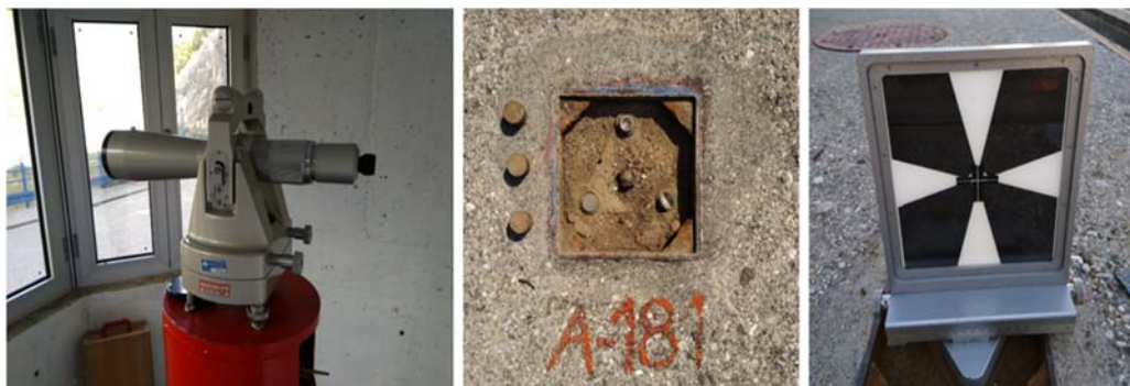
Slika 3. Mjerni instrument (alinjator), stabilizacija kontrolne tačke i mjerna markica
