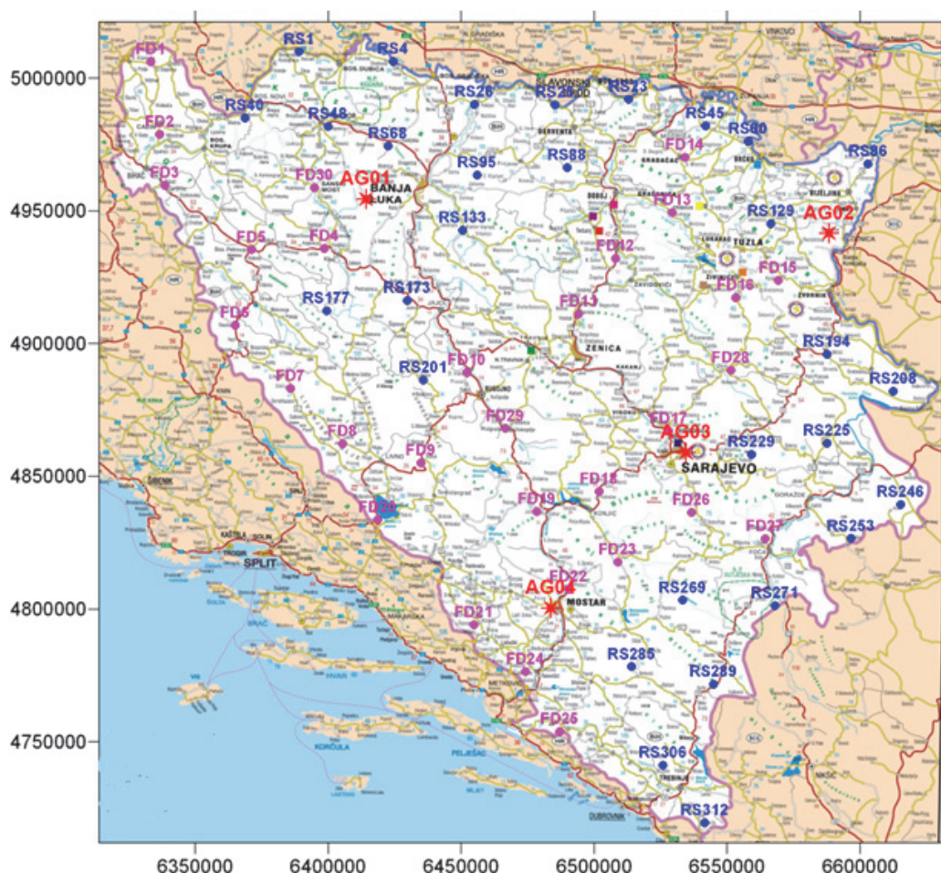
Slika 4: Dispozicija tačaka Osnovne gravimetrijske mreže Bosne i Hercegovine. U ružičastoj boji su prikazane stanice u Federaciji BiH, plavoj boji stanice u RS, dok crvene zvjezdice predstavljaju stanice apsolutne gravimetrije.
