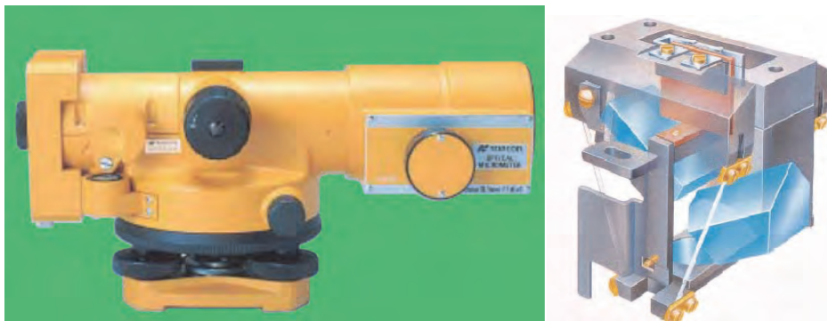
Slika 11: Nivelir Topcon AT-G1 s optičkim mikrometrom (lijevo) i izgled kompenzatora (desno) (URL 10)
