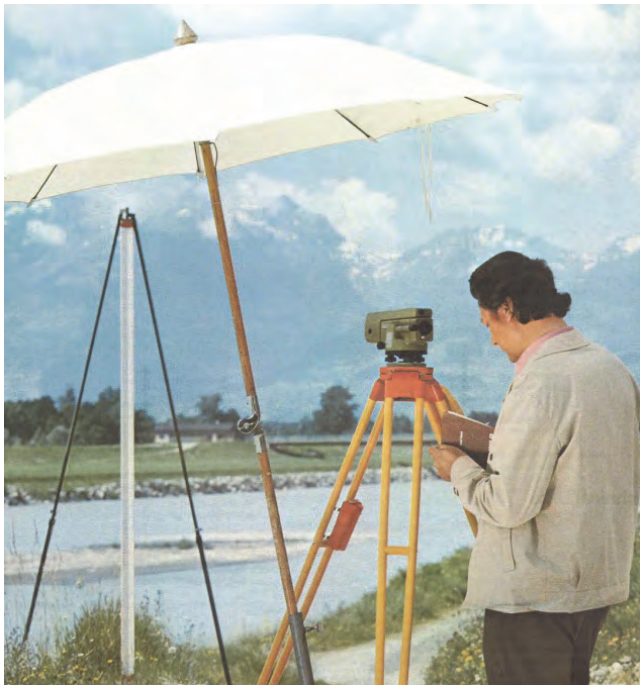
Slika 1: Niveliranje preciznim nivelirrom (lijevo); izgled vidnog polja durbina i optičkog mikrometra (desno) (Wild Leitz, 1990)
