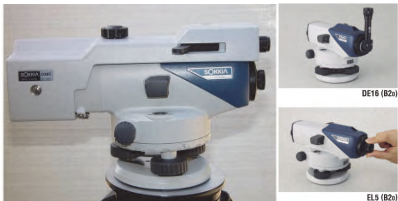
Slika 9: Nivelir Sokkia B20 s optičkim mikrometrom (lijevo) (URL 6) i različitim dodacima (desno) (URL 5)
