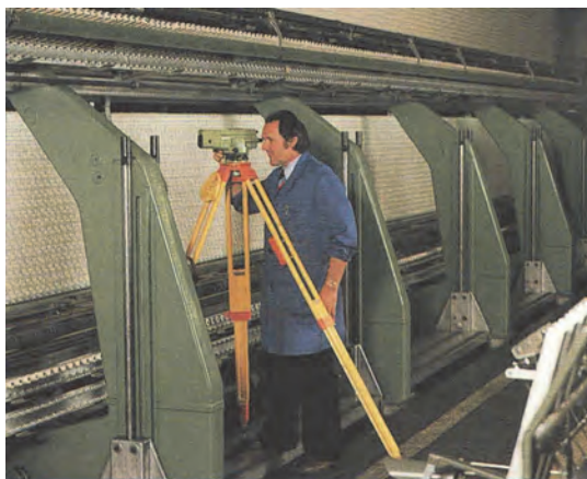
Slika 6: Industrijska mjerenja nivelikom NA2 (URL4)
