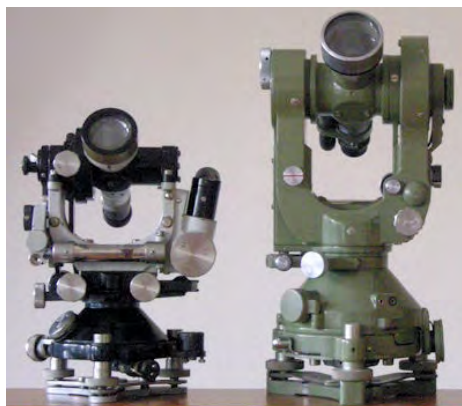
Slika 1: Usporedba prvih optičkih teodolita: Zeiss Th1 (lijevo), Wild T2(desno) (URL 4)
