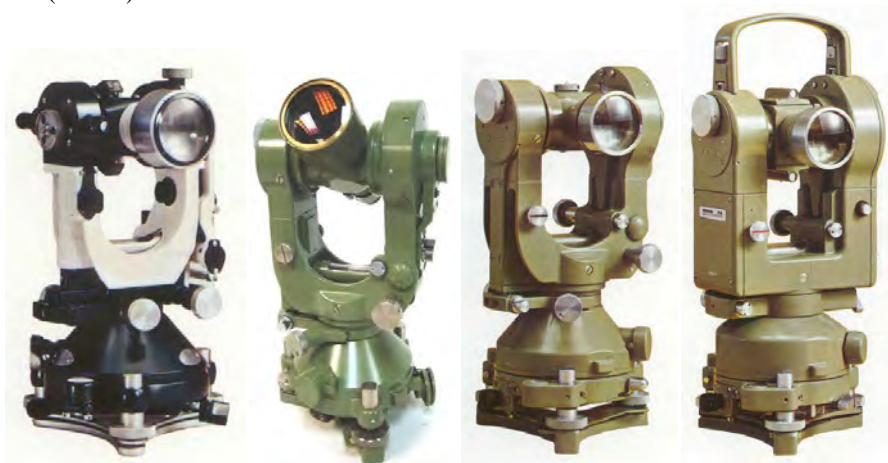
Slika 3: Teodoliti T-2, N T-2, T21, T210, T-2 mod (URL 2)
