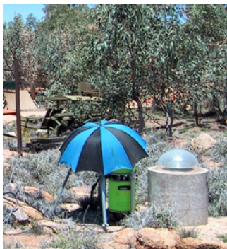
A-10 apsolutni gravimeter korišten u Australiji, 2003. godine (+30C). (URL 1)
