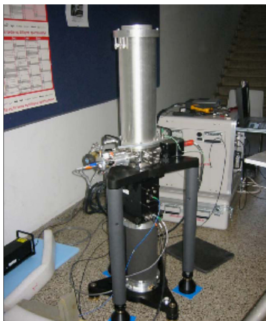
Slika 1: Gravimetar FG5 (Forsberg i dr, 2005)
